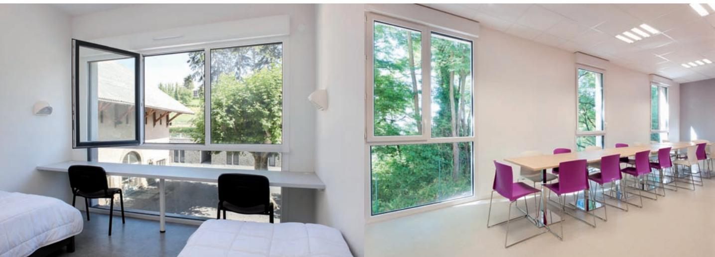
Les profilés VEKA SOFTLINE 70 ont été choisis pour fabriquer les menuiseries, baies, fenêtres mais aussi l'ensemble des portes de sécurité et portes de sortie, en bicoloration plaxée. En effet, sur les conseils des ABF, un plaxage gris anthracite pour l'extérieur a été conseillé pour les menuiseries, l'intérieur restant blanc.
